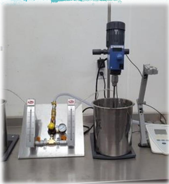
Reactor para destrucción de Cianuro
